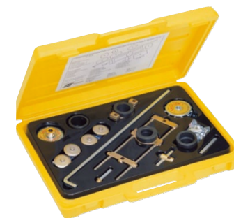
Cyrkiel Deluxe (fi 45-1060 mm) Zestaw przeznaczony do wycinania kół z magnesem lub przysawką pneumatyczną oraz do prowadzenia prostoliniowego. Stosowany w uchwytach PT-38/39
